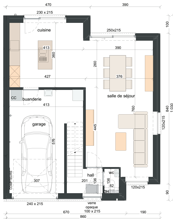
REZ-DE-CHAUSSÉE SURF. ± 83 M 2
